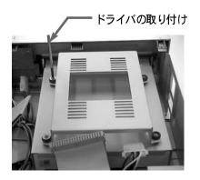
4. 電源ケーブル、信号通信ケーブル (IDEケーブル)、ファンケーブルを抜き、次にHDDブラケットを 製品の中央に向かって引っ張って底に固定された部分を外し、本製品からHDDブラケット(A)を 取り外します。HDDブラケット(B)を、ネジを取り外してから上に持ち上げて取り外します。
